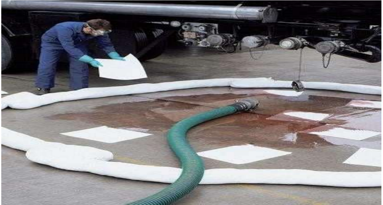
Hình 3.16. Mô tả Sử dụng phao quây dầu tấm thấm dầu để thấm hút dầu tràn
